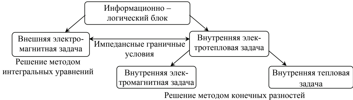
Рис.4. Принцип построения электротепловых моделей в среде Universal 2D
